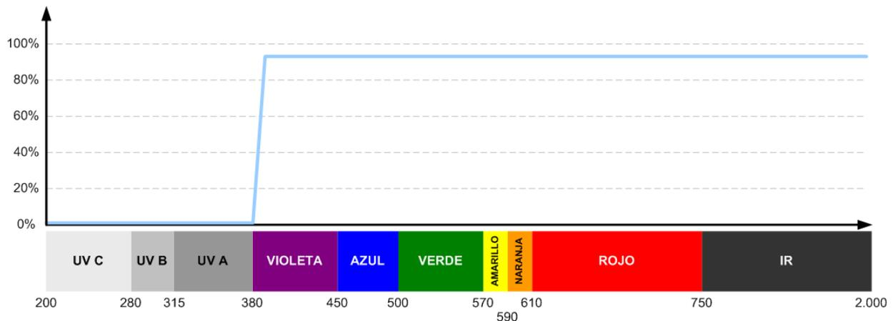
**Amarela ou âmbar:** filtra a luz visível cor azul, aumentando o contraste e a percepção de profundidade. Indicado para tarefas em ambientes onde se necessita a ampliação da acuidade visual. Não é recomendado para ambientes com luz brilhante ou quando se necessita reconhecimento de cores.
