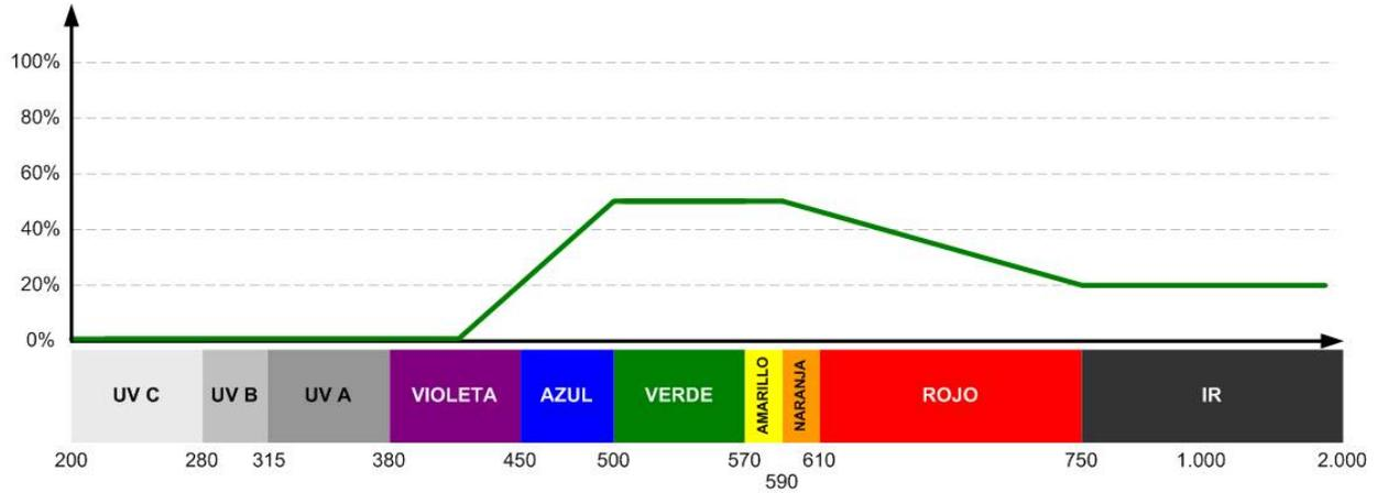
**Cinza Fumê:** indicado para uso exterior onde a luz solar possa causar fadiga visual. Proporcionam bom reconhecimento de cores.
